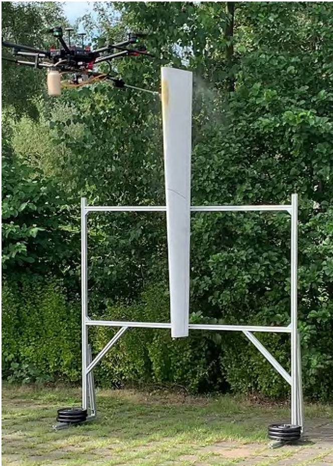
Abb. 1 Lackierdrohne im Sprühversuch: Beschichtungsmaterial wird von der Lackierdrohne über eine Lanze appliziert.
