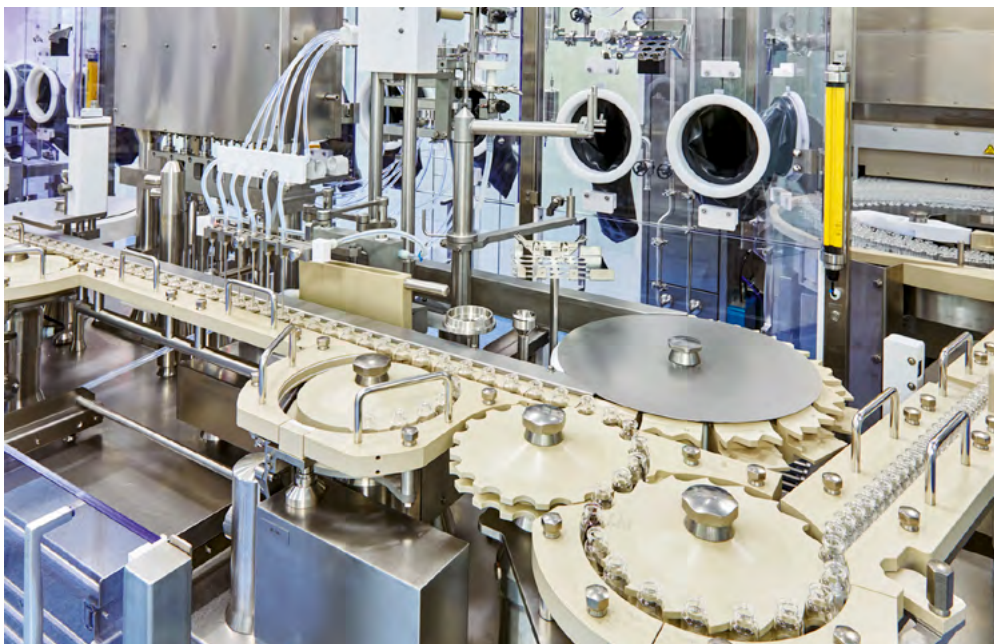
Abfülllinie mit RABS-Technik. (Quelle: Vetter Pharma International GmbH, Foto: Henry M. Linder)
