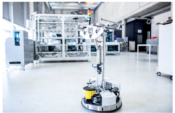
Bild 4: Mit einer geteilten Rechenarchitektur ist es Fahrerlosen Transportfahrzeugen (FTF) möglich, Kollisionen selbstständig zu umgehen. (Quelle: Universität Stuttgart IFF/ Fraunhofer IPA, Foto: Stephan Maier)
