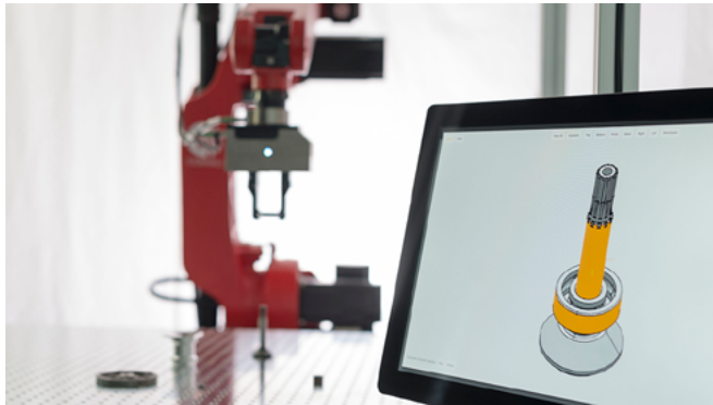
Bild 2: CAD-basierte Programmierumgebung: Montageabläufe wie das Einführen von Achsen in Lager werden am CAD-Modell durch Markieren der beteiligten Flächen (gelb) oder Bauteilelemente beschrieben. (Quelle: fortiss)
