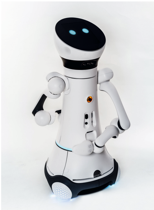
Der neue Serviceroboter Care-O-bot® 4 ist modular aufgebaut und lässt sich je nach Bedarf individuell konfigurieren. (Quelle: Fraunhofer IPA)
