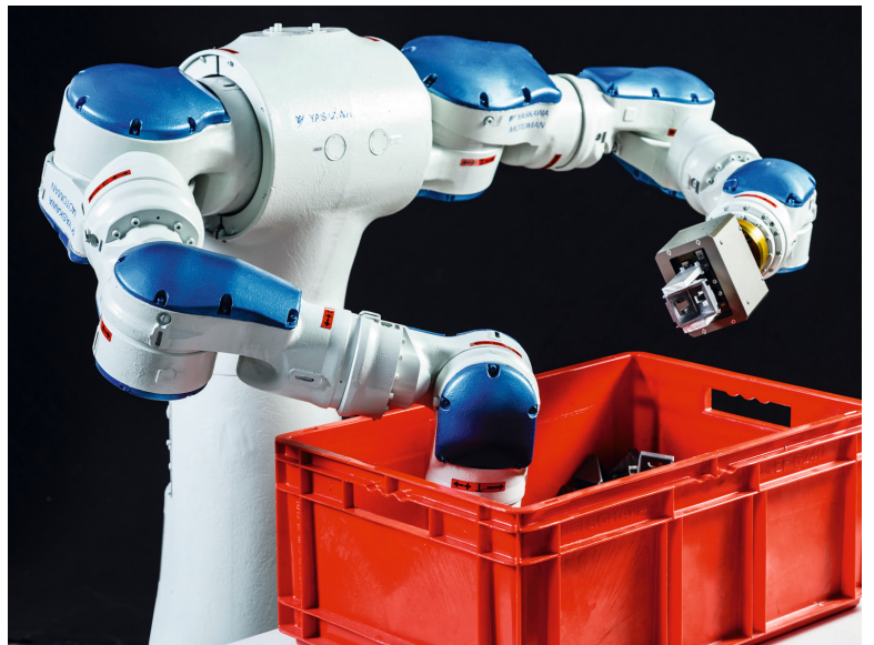
Das Robotersystem Rapid Dual Arm Bin Picking vereinzelt chaotisch gelagerte Bauteile in Rekordzeit. (Quelle: Fraunhofer IPA)
