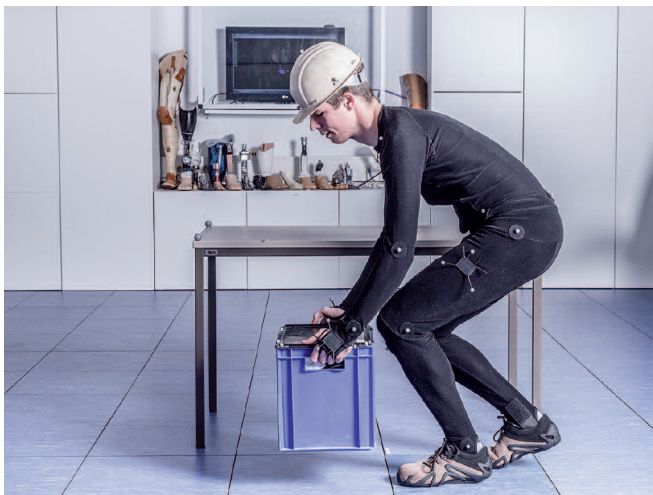
Bewegungsanalyse mit hochauflösendem Infrarot-Tracking-System. (Quelle: Fraunhofer IPA)
