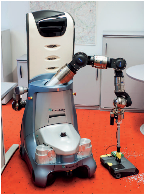
Care-O-bot® erkennt mit seinen Sensoren den Schmutz und entfernt ihn mithilfe eines speziell dafür angepassten Akkusaugers. (Quelle: Dussmann Group/Ecke)
