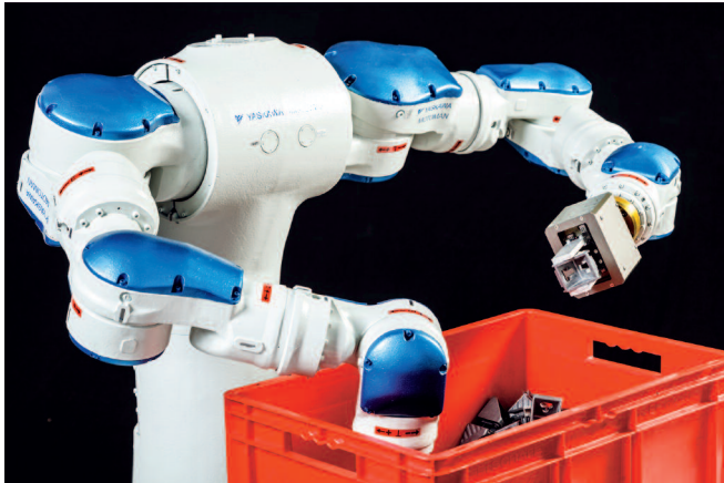
Neues zweiarmiges Robotersystem für einen schnellen Griff-in-die-Kiste. (Quelle: Fraunhofer IPA)
