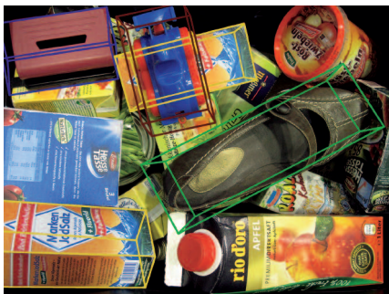
Dreidimensionale Objekterkennung unter partieller Verdeckung und variablen Lichtverhältnissen. (Quelle: Fraunhofer IPA)
