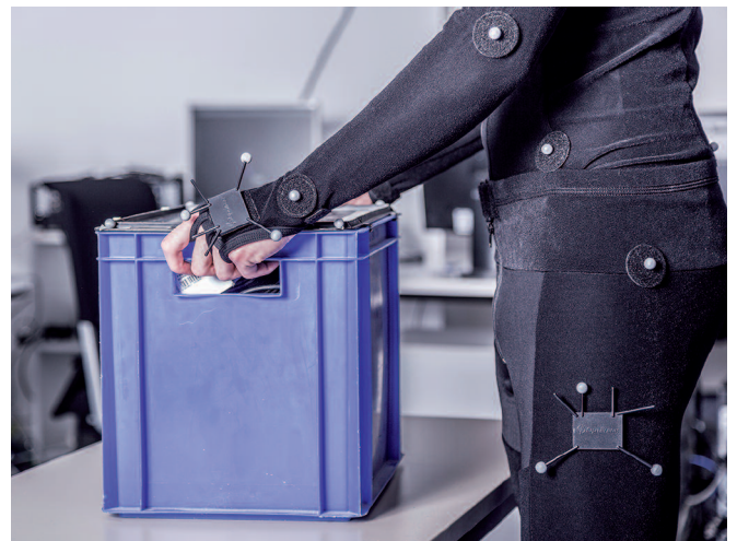
Bewegungsanalyse mit hochauflösendem Infrarot-Tracking-System. (Quelle: Fraunhofer IPA)
