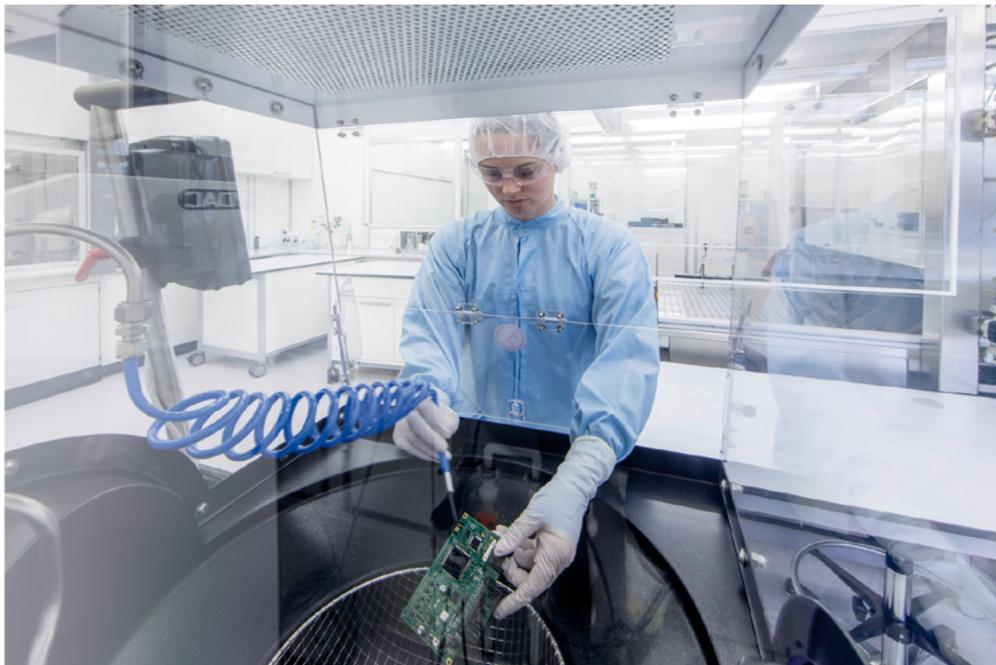
**Extraktion der Partikel von einem Bauteil nach VDA Band 19.1.**
