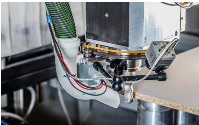
Das energieeffiziente Absaugsystem ADExSys entfernt die Emissionen bei der Bearbeitung von Leichtbaustoffen nahezu vollständig. (Quelle: Fraunhofer IPA, Foto: Rainer Bez)
